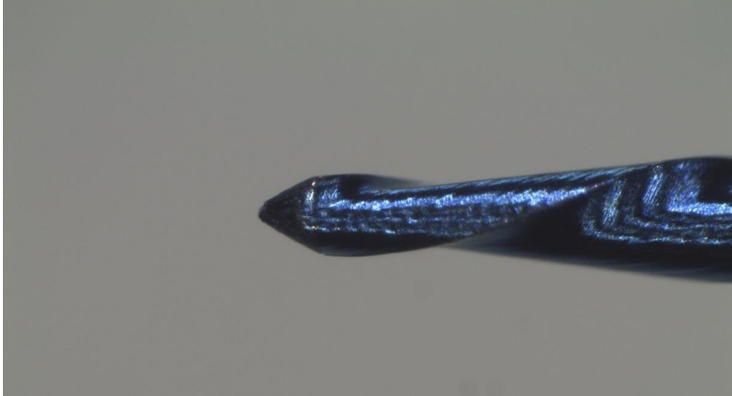
FIGURA 9. INSTRUMENTO REC BLUE FILE (DENTALINE) VISTA BAJO ESTEROMICROSCOPIO 10X DE AUMENTO
