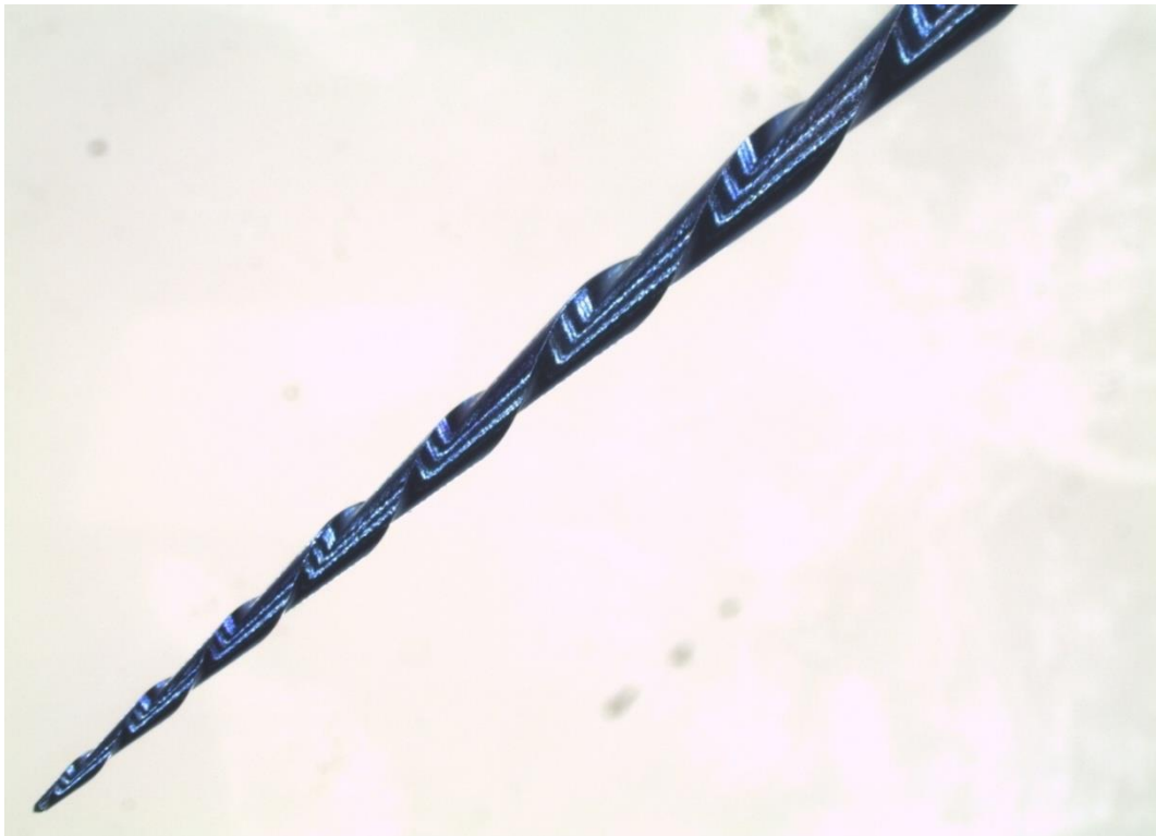
FIGURA 7. INSTRUMENTO RC BLUE (D-PERFECT) VISTA BAJO ESTEROMICROSCOPIO 10X DE AUMENTO
