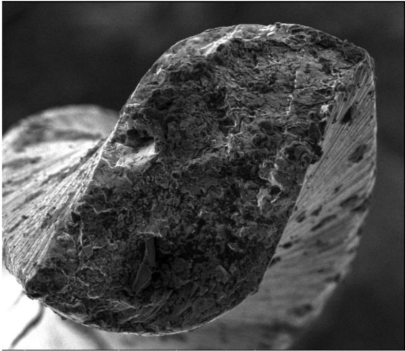
FIGURA 10. Microscopía electrónica de barrido de fragmento de lima Mtwo a 550X
