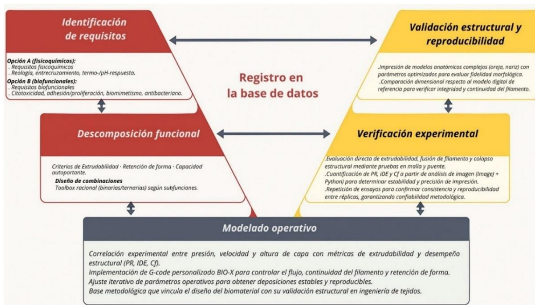
Figura 3.5: Modelo en V adaptado al diseño de sistemas de bioimpresión. Este enfoque metodológico permite vincular de forma estructurada las etapas de diseño funcional de las formulaciones (lado izquierdo) con las fases de validación experimental y verificación (lado derecho).
