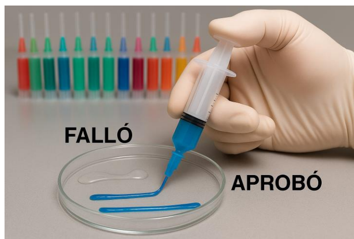
Figura 4.2: Se muestra la dispensación de una tinta azul sobre una placa Petri mediante jeringa con aguja 22G. La línea inferior conserva continuidad y forma(extruable), mientras que la línea superior presenta pérdida de definición y extensión irregular (no extruable). Esquema de autoría propia-generado con asistencia de la inteligencia artificial Chat-GPT.
