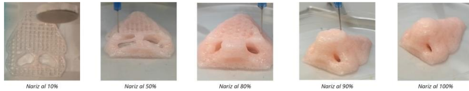
Figura 5.32: Impresión del modelo anatómico de nariz en distintas etapas de avance (10 %, 50 %, 80 %, 90 % y 100 %) utilizando la formulación Xa3 %–A12 %.
