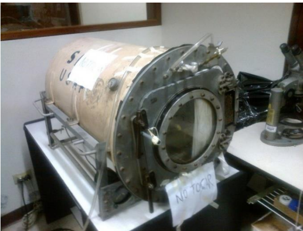
Figura 5: La presente figura muestra la cámara hipobárica donde se alojaron los animales por 3 semanas.
