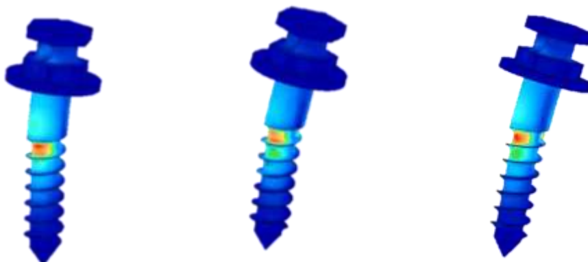
Figura 5. Tensión del mini-implante DEWIMED 6 x 1.6 mm insertado a 50°, 70° y 90° en un modelo óseo con cortical de 1.5mm bajo una fuerza unidireccional de 2N.
