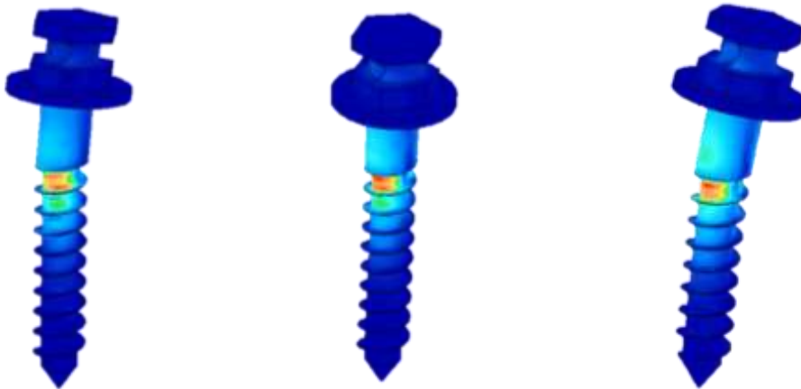
Figura 7. Tensión del mini-implante DEWIMED 8 x 1.6 mm insertado a 50°, 70° y 90° en un modelo óseo con cortical de 1.5mm bajo una fuerza unidireccional de 2N.
