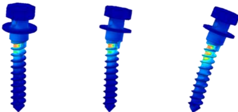
Figura 8. Tensión del mini-implante AARHUS 6 x 1.5 mm insertado a 50°, 70° y 90° en un
