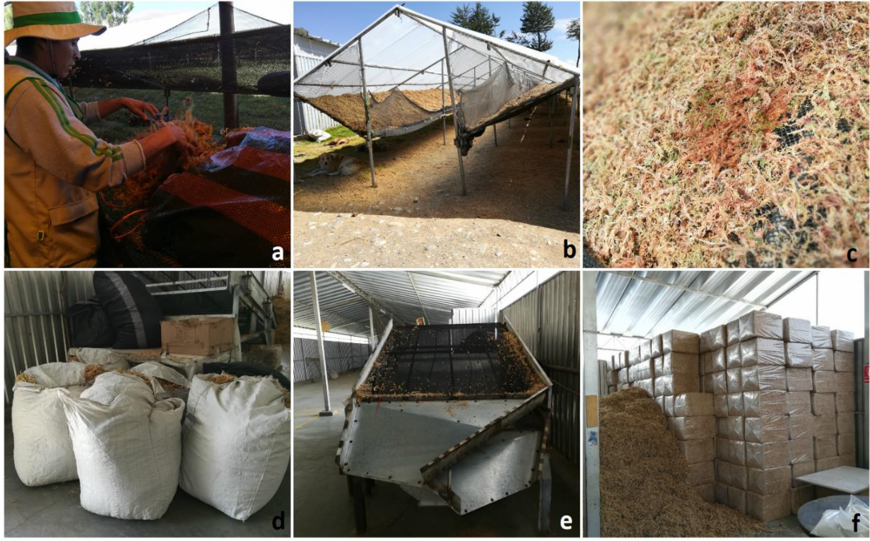
Figura 11.- Proceso de manufactura del musgo blanco de la empresa Inka Moss S.A.C. a) Colecta del musgo del campo y limpieza b) Camas de secado c) Musgo en proceso de secado d) Musgo seco listo para prensar e) Prensa hidráulica f) Musgo prensado y empaquetado.
