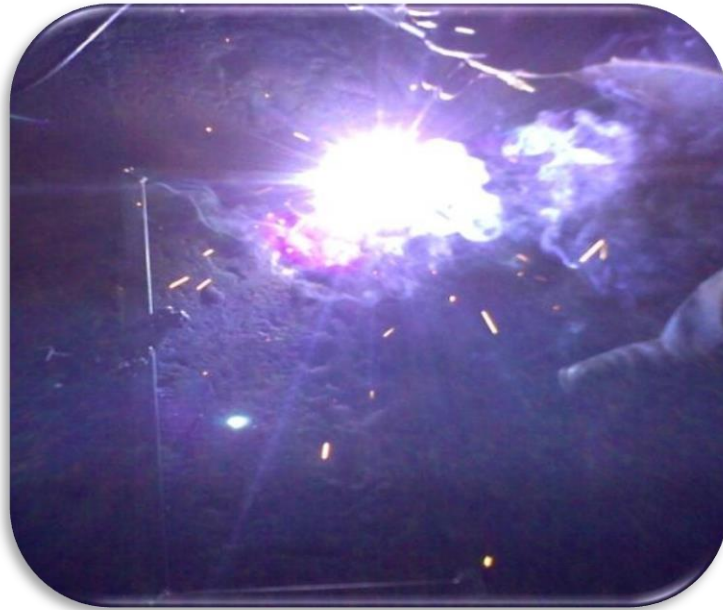
Figura 12. Unión de ángulos mediante soldadura
