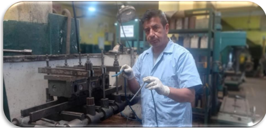
Figura 6. Probador de culatas de motor
