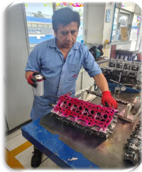
Figura 30. Foto de la preparación de culata para detectar fisuras y rajaduras.
