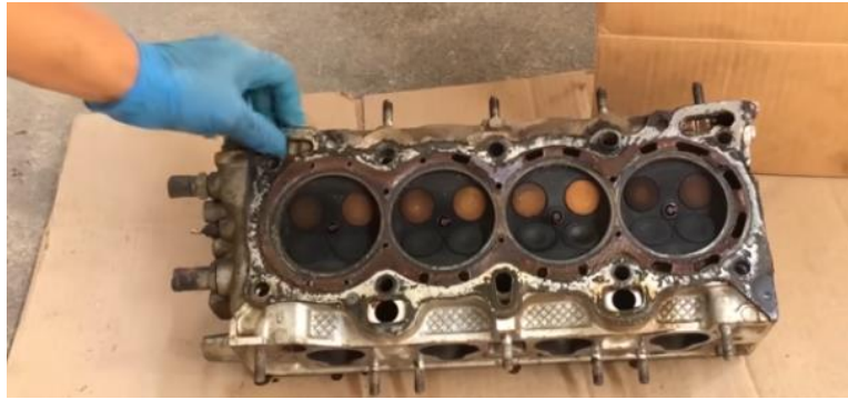
Figura 2. culata y empaquetadura para realizar detección de fallas
