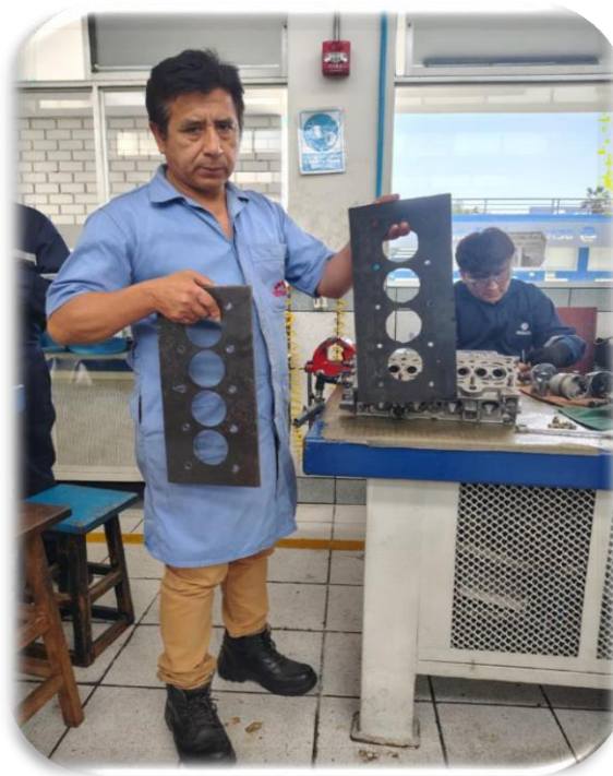
Figura 26. Foto de plancha metálica. para cubrir conductos de refrigeración.
