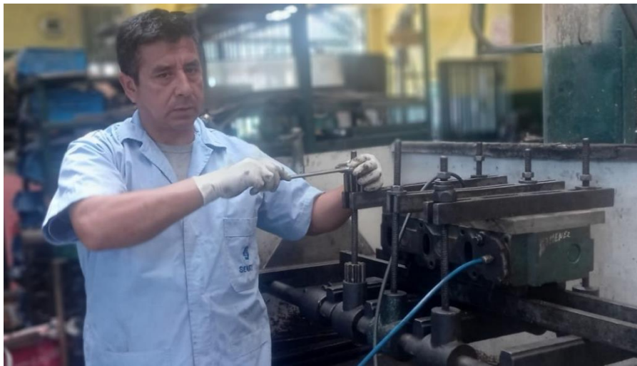
Figura 3. Banco de pruebas hidrostática de culata
