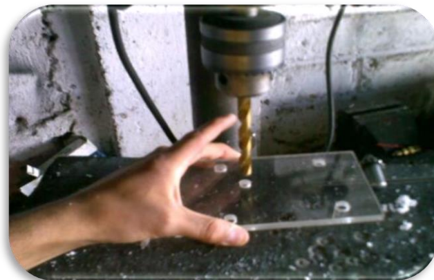
Figura 20. Perforación de tapas laterales
