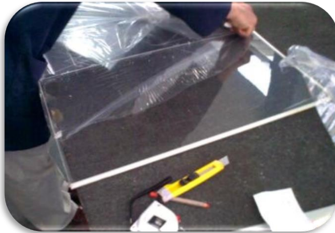
Figura 16. Corte en acrílico de la tapa superior de culata
