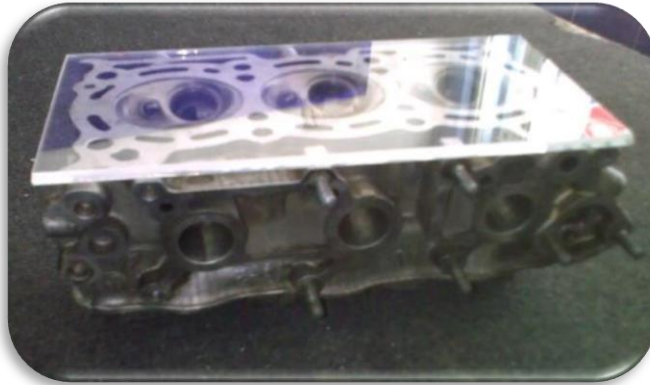
Figura 17. Tapa superior de culata terminada
