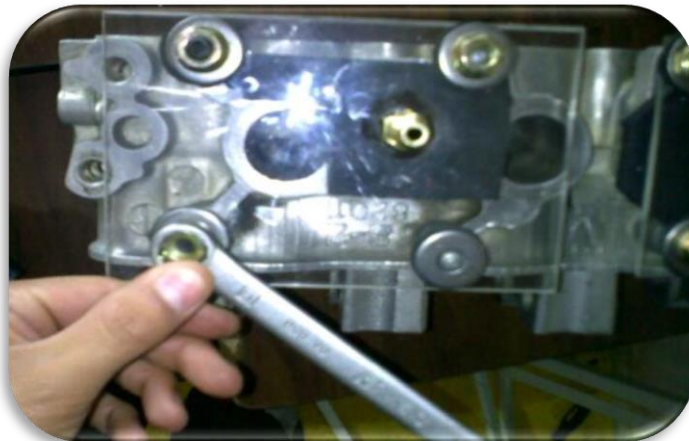
Figura 22. Apriete del acrílico contra la fibra celulosa
