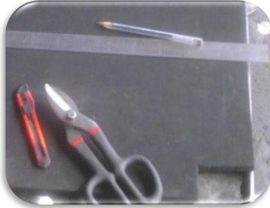
Figura 21. Corte de la fibra celulosa
