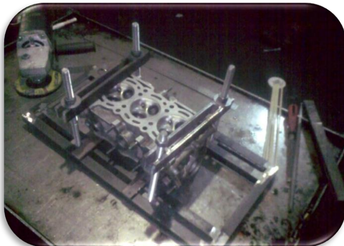
Figura 24. Soporte y tapas de culata terminados
