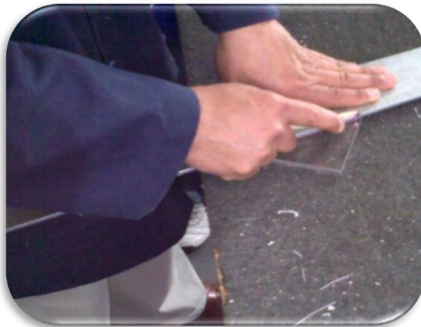
Figura 18. Corte en acrílico de tapas laterales de la culata
