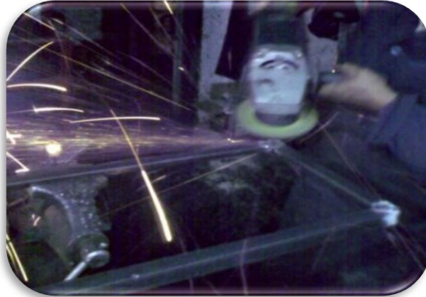
Figura 14. Desbastando aristas vivas del soporte de la culata
