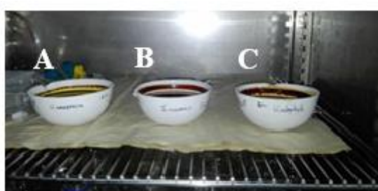
Fotografía 11. Secado de los extractos crudos de las cortezas vegetales en la estufa A) V. amazonica B) I. juruensis C) V. calophylla
