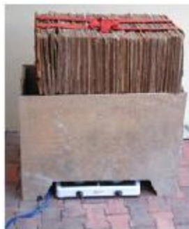
Figura 8. Prensa armada dentro de la secadora eléctrica para plantas
