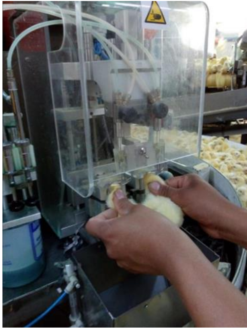
Figura 4. Colocación de ave en máquina vacunadora automática Jecmatic: la aguja ingresa en tercio medio dorsal del cuello del ave
