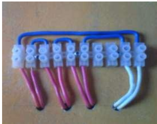
Figura N°3. Instalación de un Circuito serie
