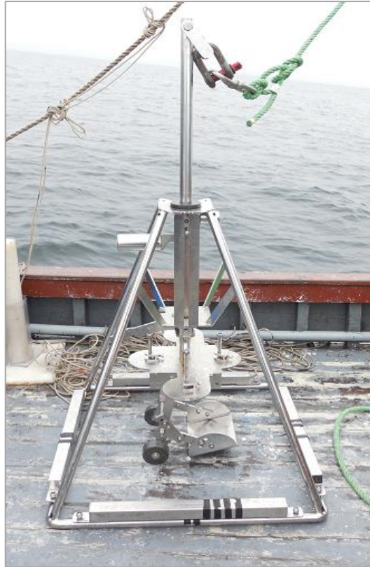
Figura 4. Muestreador de sedimentos HAPS Corer usado en el estudio espacio estacional.
