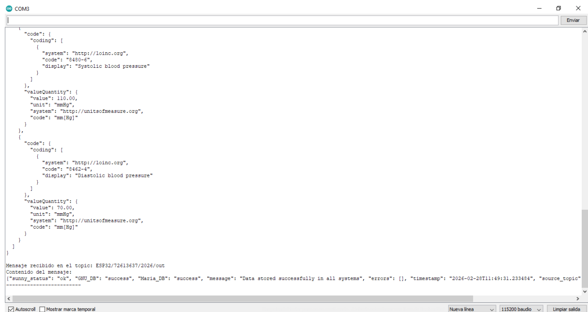
Figura 50. Recepción del mensaje de confirmación (ACK) en el monitor serial del ESP32 (Parte 1).
