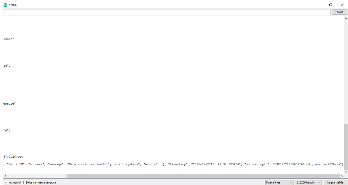
Figura 51. Recepción del mensaje de confirmación (ACK) en el monitor serial del ESP32 (Parte 2).
