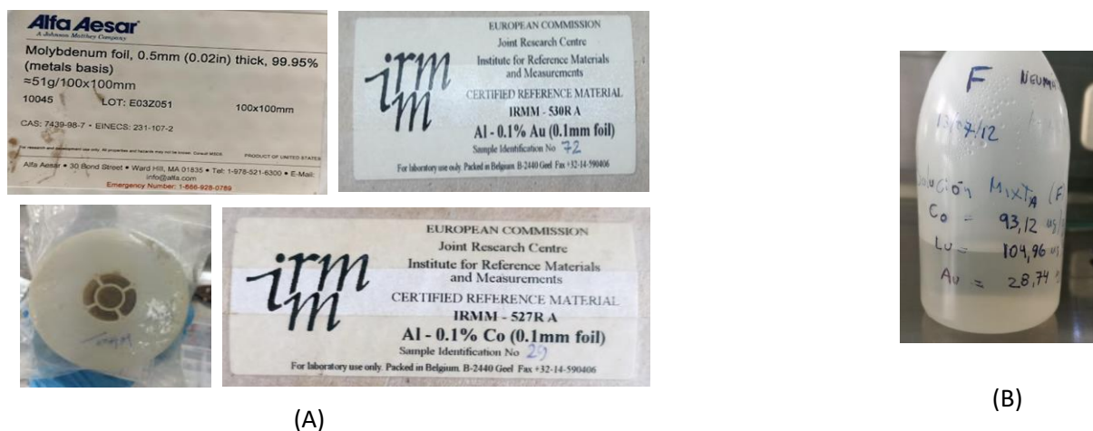
Figura 7. Monitores de flujo neutrónico. (A) Monitores en lámina: Co, Mo y Au y en alambre: Lu (B) Monitores en solución mixta: Co, Lu y Au (no se dispone de la imagen del Mo en solución).
