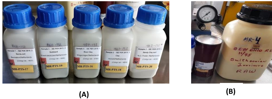
Figura 4. Muestras empleadas en el AANI-ko. (A) Patrones internos WEPAL y (B) envase derecho: material de referencia Ohio Red Clay y envase izquierdo: material de referencia certificado Montana Soil II.
