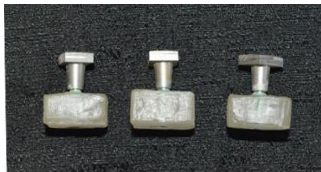
Figura 6. Muestras después del cementado y la limpieza de excesos del agente cementante, previo al retiro de los bloques de acrílico para iniciar con las mediciones en el microscopio.
