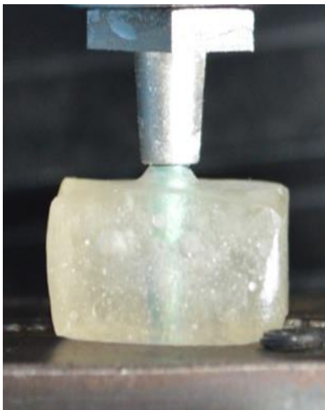
Figura 1. Envase personalizado para el estudio con acrílico de combustión completa (DuraLay Inlay Resin – Standard Package - Reliance Dental Mfg Co.), donde se ubicaron los análogos del pilar posicionando la plataforma 2mm sobre la superficie superior del acrílico.
