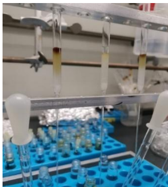
Figura 24. Separación de componentes vía columna.
