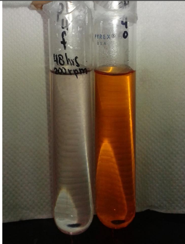
Solución a pH óptimo (4.0) de adsorción, antes y después de la adsorción, con quitosano en polvo
