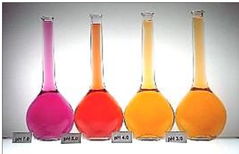
Figura N° 16: Variación del color con el pH de la solución de ácido carmínico. [35]
