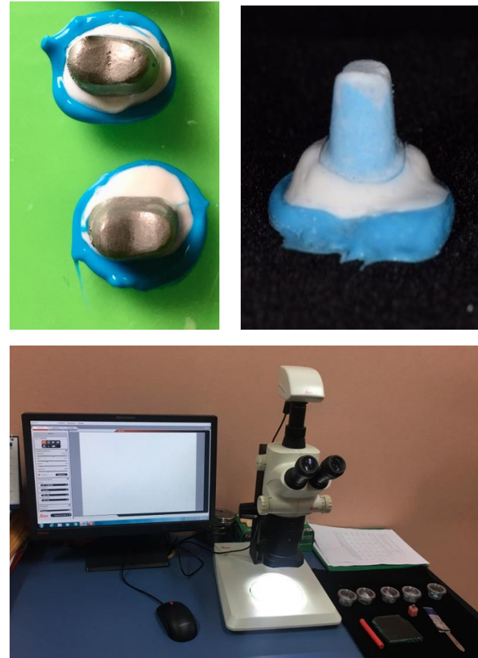
FIGURA 6. Estereomicroscopio Greenough Leica S8 APO
