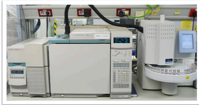
Imagen 1. Se muestra el equipo de Cromatografía de Gases acoplada a masas (GC-MS) empleado en el estudio.
