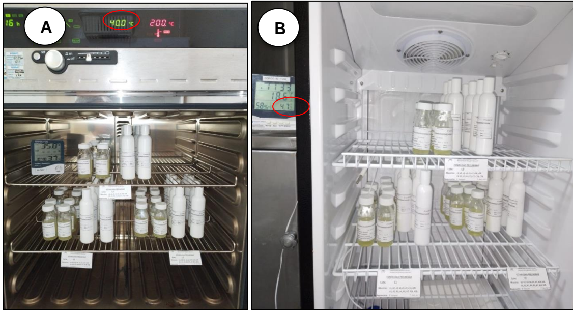
Figura N°2: Incubación de muestras del Gel Capilar Cosmético a 5 \pm 2 °C (A) y a 40 \pm 2 °C (B) para Estudio de Estabilidad Preliminar.
