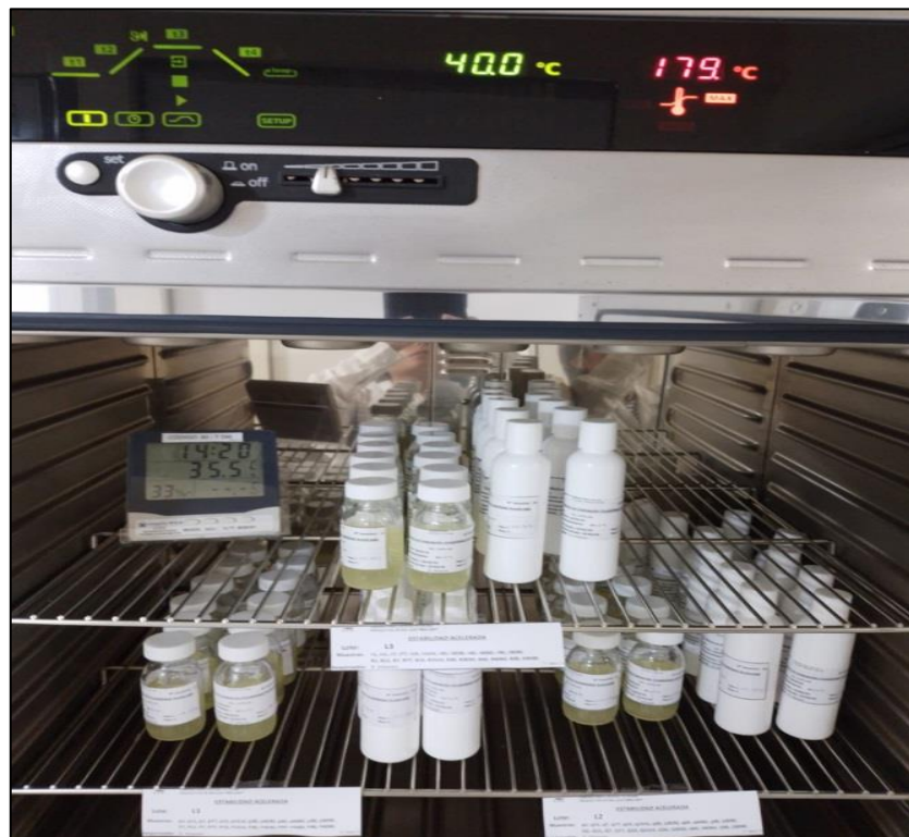
Figura N°3: Incubación de muestras del Gel Capilar Cosmético a 40 \pm 2 °C para Estudio de Estabilidad Acelerada.
