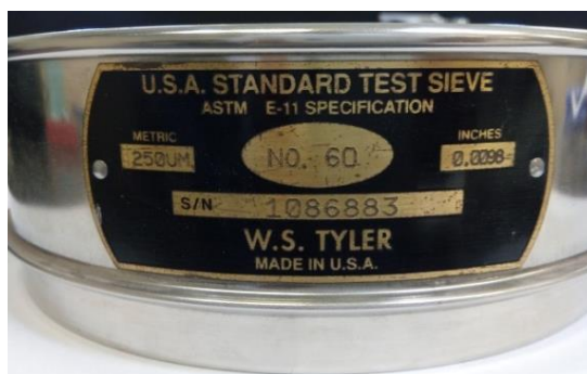
Figura 22. Malla de acero N° 60 usada para obtener partículas de tamaño homogéneo.
