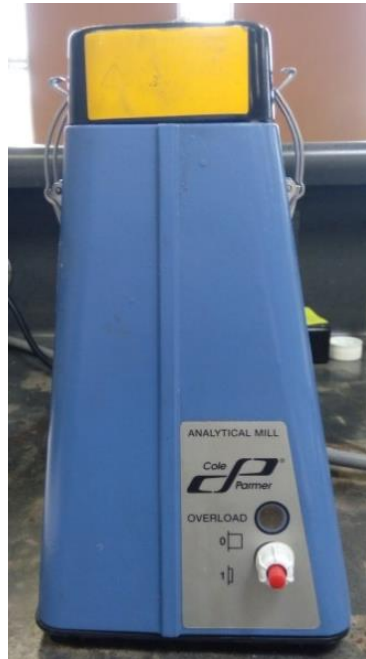
Figura 21. Molino analítico usado para la reducción de tamaño de partícula.
