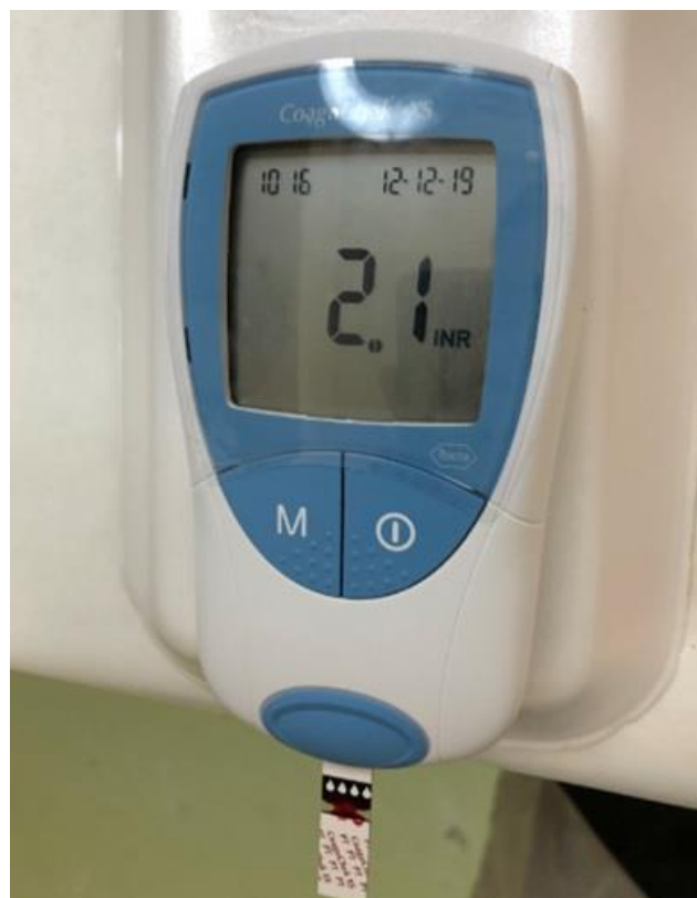
Figura 08. Procesado de la muestra con el CoaguChek XS® (Roche) y estimación del valor INR.
