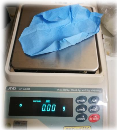
Calibración de balanza con opción de TARA
