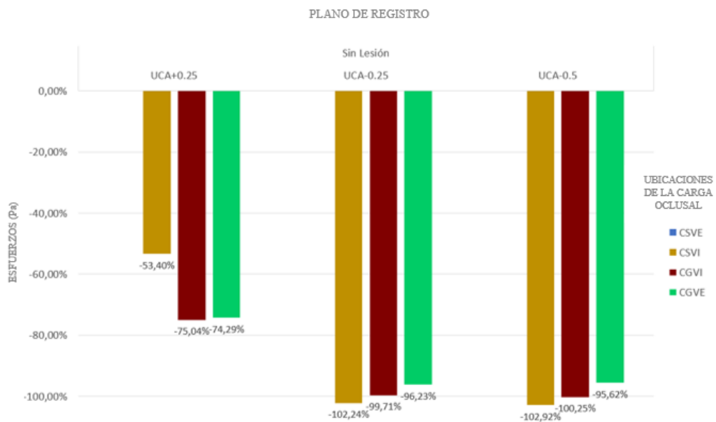
Gráfico 4. Diferencia porcentual de la distribución de esfuerzos cuando se aplica la carga sobre la cúspide de soporte vertiente interna, la cúspide guía vertiente interna y la cúspide guía vertiente externa en la pieza sin lesión según el plano de registro y punto de aplicación de la carga, tomando como referencia comparativa la cúspide de soporte vertiente externa
