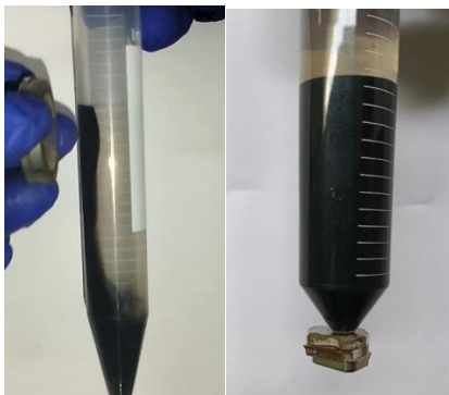
Figura 4. Ensayo preliminar de respuesta magnética mediante aproximación de un imán previo al proceso de secado.
