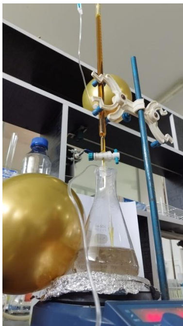
Sistema de coprecipitación para la síntesis de \text{Fe}_3\text{O}_4
