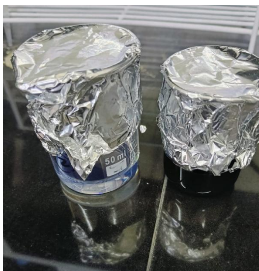
Soluciones precursoras empleadas en la síntesis del MOF: a la derecha, solución 1 (ácido aminotereftálico en DMF, de aspecto claro); a la izquierda, solución 2 ( \text{FeCl}_3 \cdot 6\text{H}_2\text{O} con magnetita, de color oscuro/negro).
