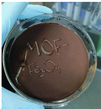
Figura 5. MOF obtenido después del proceso de secado a 70 °C.
