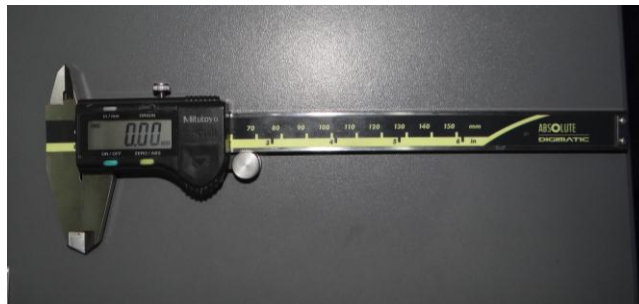
Figura 3. Uso de Calibrador digital Mitutoyo para confección de moldes de plástico
