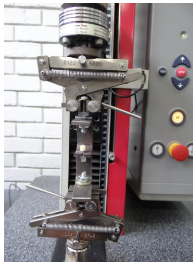
Figura 27. Máquina de ensayo universal (Zwick/Roell Z2.5 BT1-FR0.5TS.D14, Ulm-Alemania)
