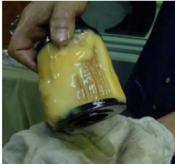
Figura 11. Foto de un filtro afectado por la gelificación del diésel. Elaboración Propia.
