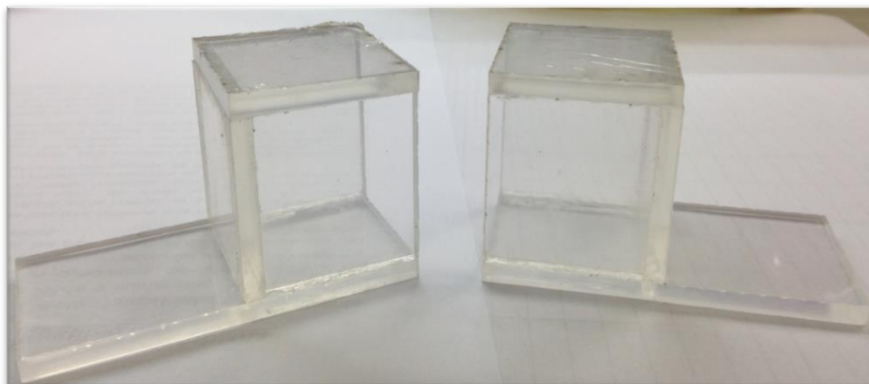
Fig.9: Semi-celdas de una Celda de Combustible Microbiana
