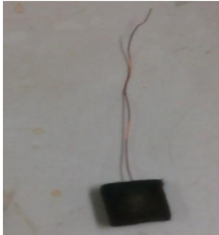
Fig.10: Electrodo de fieltro de grafito unido al alambre de cobre (Cu)
