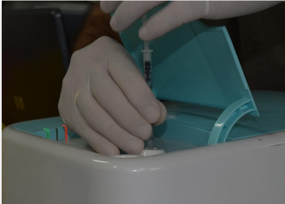
Figura 7. Se inyectó el gas remanente en la entrada del OralChroma™ Modelo CHM-2.
