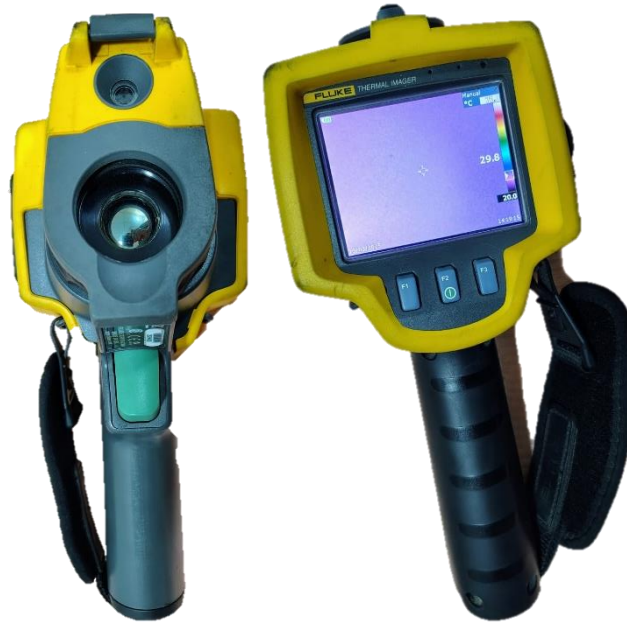
Figura 3. Cámara termográfica (Fluke Ti10) para determinar los cambios de temperatura en la superficie radicular externa de la muestra.
