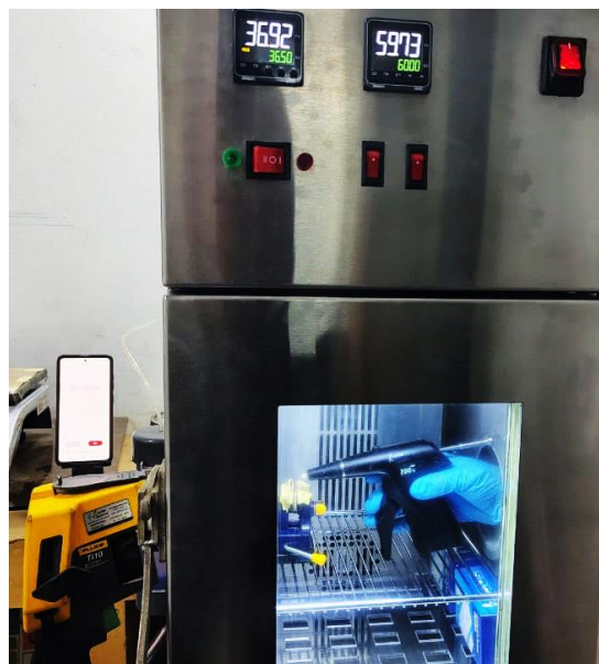
Figura 6. Medición de los cambios de temperatura durante la aplicación de la técnica de condensación de onda continua dentro de la cámara climática (I.N.G CAPESO S.A.C) adaptada a 37\pm 0.5 °C, utilizando una cámara termográfica (Fluke Ti10) y un cronómetro (lado izquierdo).
