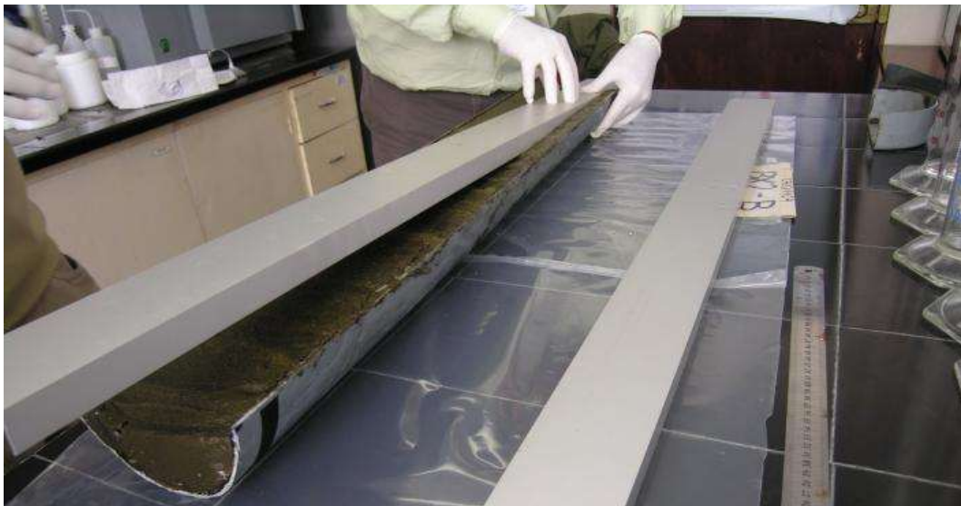
Figura 5.5. Montaje de núcleo sedimentario en perfil de aluminio de sección rectangular.
