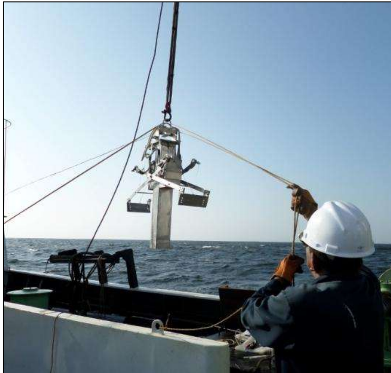
Figura 5.2. Sacatestigo de caja tipo Soutar utilizado para la recuperación del núcleo
