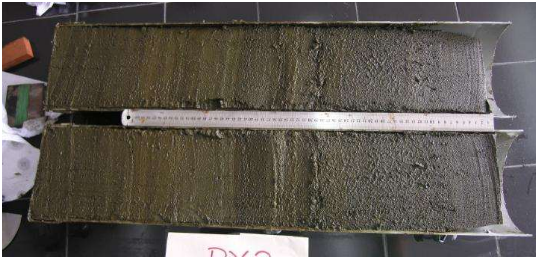
Figura 5.4. Apertura de núcleo sedimentario para la observación, descripción y submuestreo.
