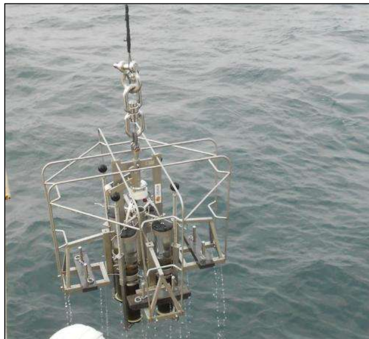
Figura 5.3. Multisacatestigos utilizado para la recuperación del núcleo.
