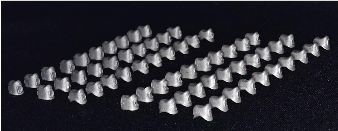
Figura 5: Cofias en Co-Cr impresas mediante SLM .
