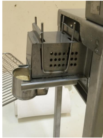
Foto No. 4:A: Vista inferior de la jaula metabólica, B. Cesta donde quedan retenidas las excretas.
