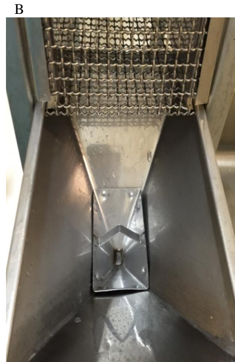
Foto No. 4:A: Vista inferior de la jaula metabólica, B. Cesta donde quedan retenidas las excretas.
