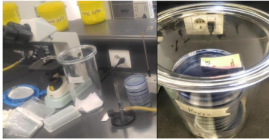
Figurs 4: Placas de Agar Mitis Salivarius incubadas a 37°C por 48 horas en jarras de anaerobiosis con bolsas de anaerobiosis y con su respectivo indicador
